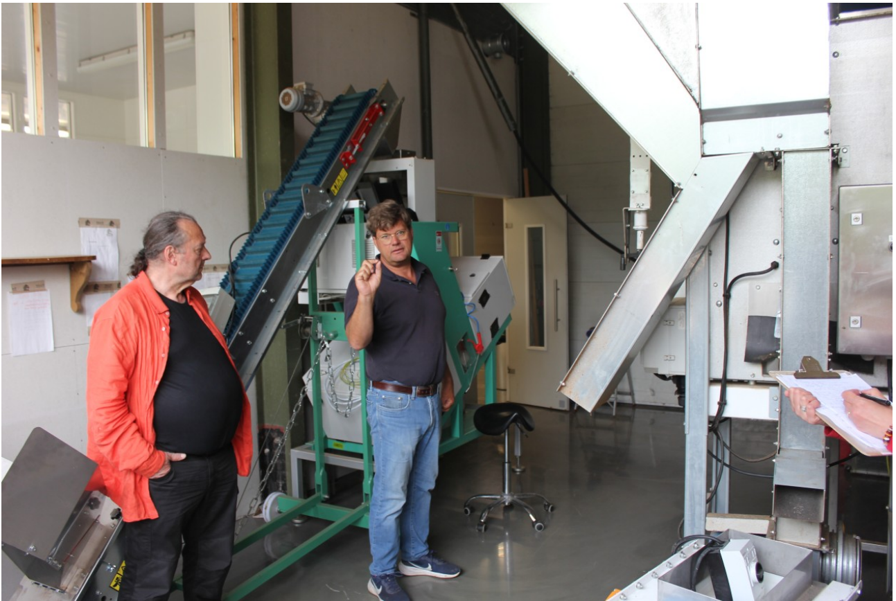
Nötknäckningsanläggningen för valnötter (höger) och den optiska sorteringsmaskinen (vänster)
